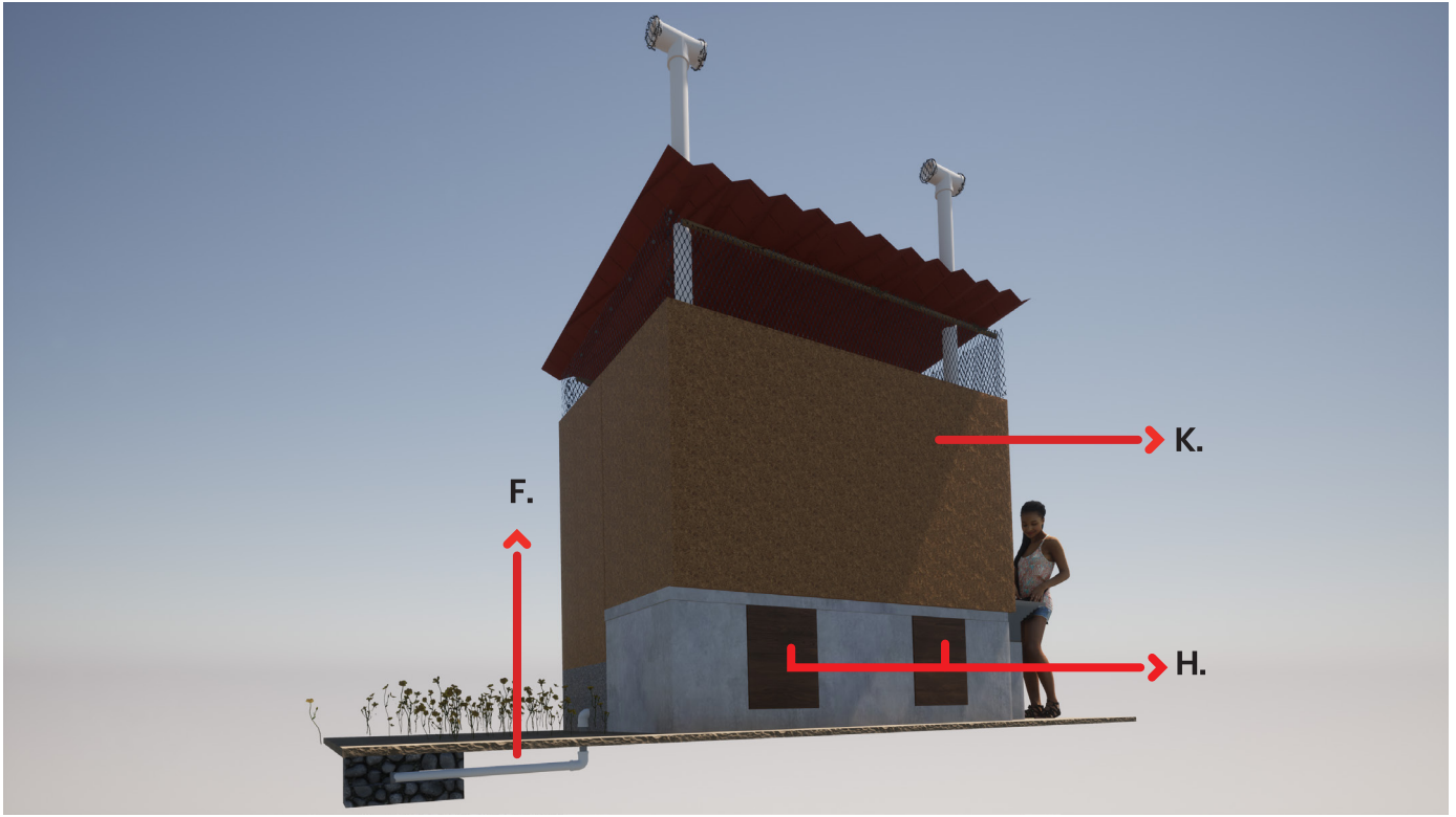
FIGURA 2. Vista trasera del baño seco.
